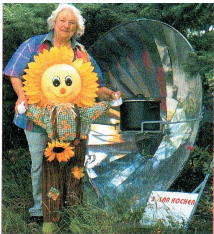
Die Kindergärtnerin vom Verein „Solar-Kochschule“ hat sich dem Kochen mit Sonnenenergie verschrieben. Der Solarkocher bündelt die Sonnenstrahlen
